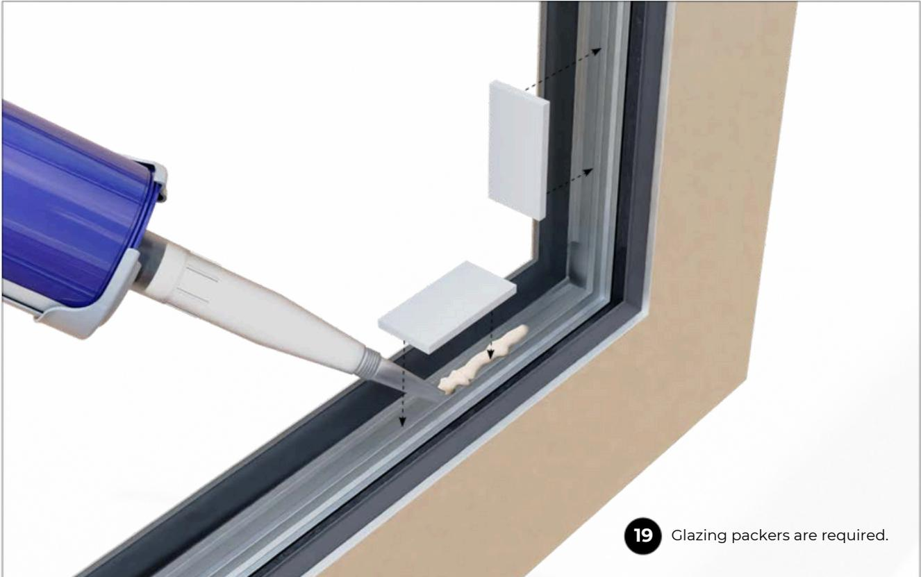
IT IS RECOMMENDED TO POSITION THE GLAZING PACKERS ACCORDING TO THESE CONFIGURATIONS.
